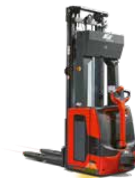
Vorbereid om met AGV te communiceren en te werken 15 pallets/500 kg
